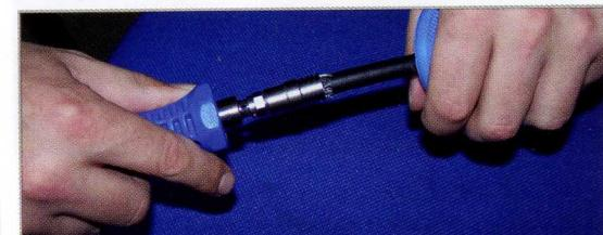
На кабель с поливинилхлоридной оболочкой он ставится легко, можно даже эти приспособления не использовать. А вот для кабеля с тросом, где перемычка между оболочкой кабеля и тросом снята плохо, для кабеля с полизтиленовой оболочкой эти приспособления в самый раз. Уж как эту полизтиленовую оболочку только не мучают, и зажигалкой ее плавят, и ножом монтажным подстрагивают, все потому, что лучше этой оболочки для наружной прокладки ничего нет, а разъем монтируется тяжело.
