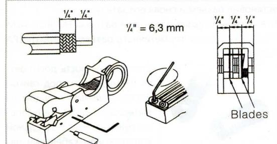
производим регулировку глубины разреза шестигранным ключом из комплекта инструмента, как показано на рисунке. Вращение по часовой стрелке увеличивает глубину реза, поднимая лезвие, против часовой стрелки – уменьшает.
