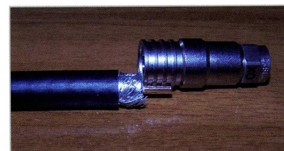
Далее аккуратно загибаем проволочную оплётку на оболочку и стараемся равномерно распределить ее по окружности. В противном случае делаем горб из оплётки в одном месте и мучаемся при монтаже разъема.
